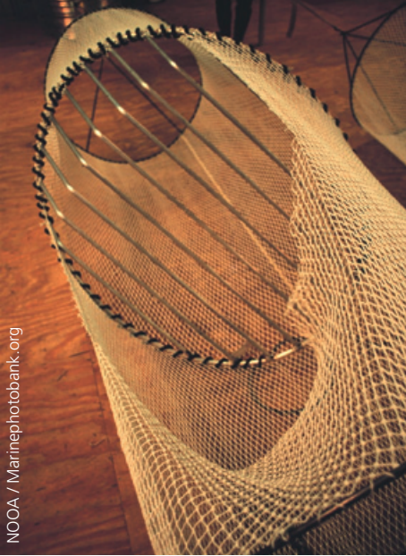
Darstellungen einer Schildkrötenschlupfsperre (Turtle Excluder Device, TED)
